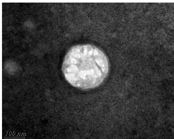
Figure 34 : Observation en MET d'une particule de LASO d'environ 200 nm après coloration à l'acétate d'uranyle
