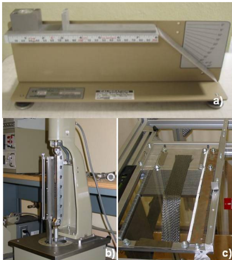
Figure 71: Dispositifs de mesure de flexion statique :
