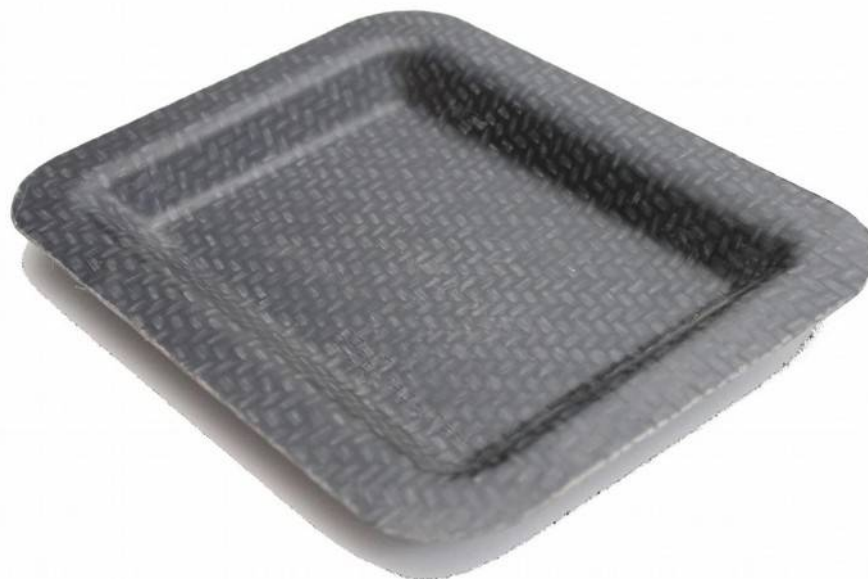
Figure 8: Plateau réalisé par thermo-estampage
