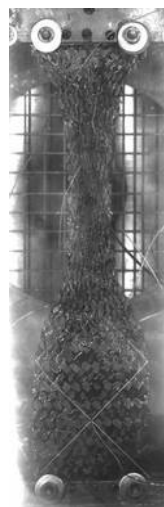
Figure 99: Bias-extension test à une température non homogène, proche de la fusion de la matrice
