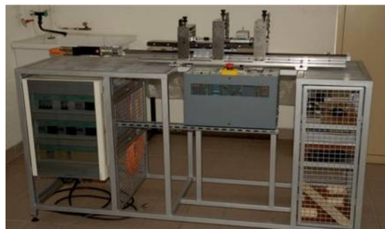
Figure 74: Schéma de mesure du coefficient de frottements [TEN 2008]
