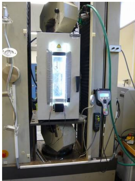
Figure 136: Bias-extension test en température
