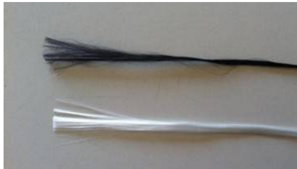
Figure 2: Mèches de fibres longues (carbone et verre)
