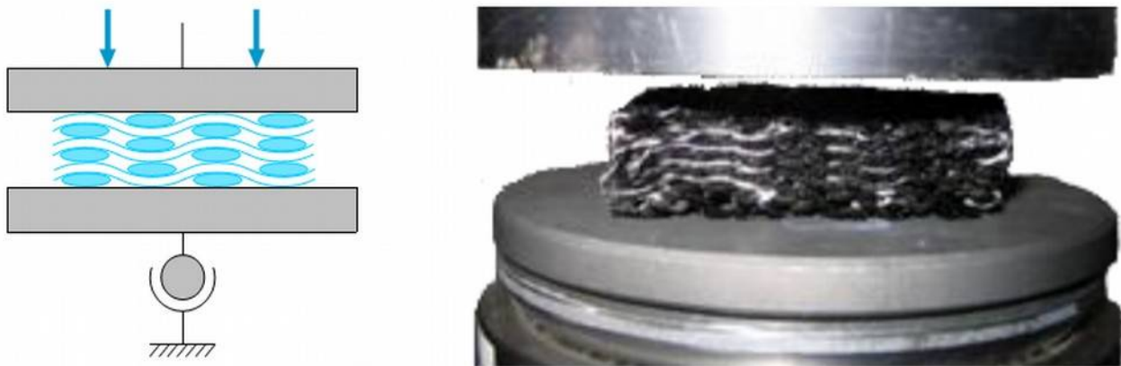
Figure 73: Essai de compression transverse sur tissu épais [ORL 2012]
