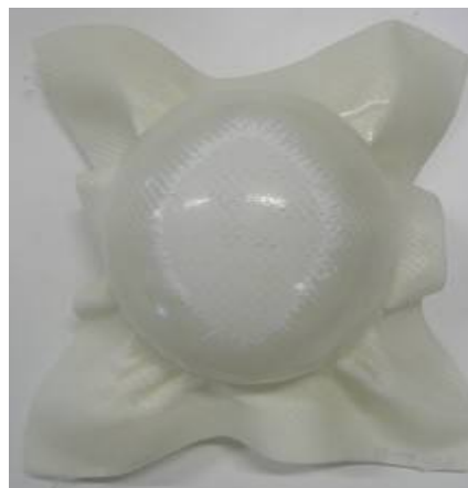
Figure 44: Manque de matrice sur le haut du dôme
