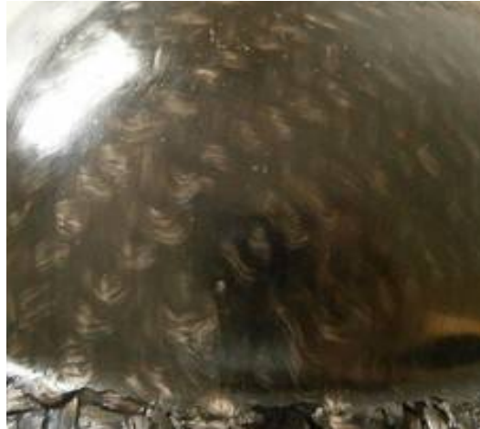
Figure 43: Flambement local des mèches transverses
