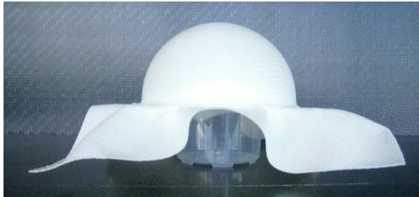
Figure 41: Plis sur la zone non utile de la pièce
