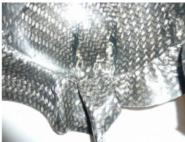
Figure 42: Exemple de plis à l'intérieur d'un hémisphère
