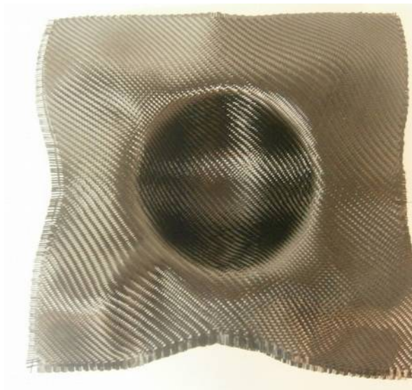
Figure 104: Hémisphère réalisé avec des tissus secs
