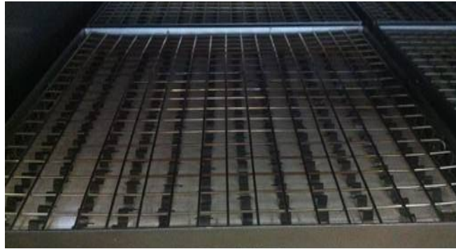
Figure 17: Lampes infrarouges à lames rayonnantes
