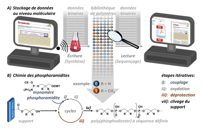
Figure 1: A) Stockage de données au niveau moléculaire par écriture de données binaires sur des polymères et leurs lecture; B) Chimie des phosphoramidites pour la synthèse de poly(phosphodiester)s numériques (montré : code binaire).
