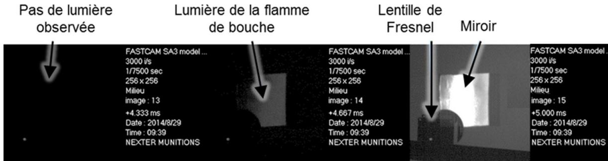
Figure V-9 : Images de la caméra rapide au moment de la sortie du projectile.
