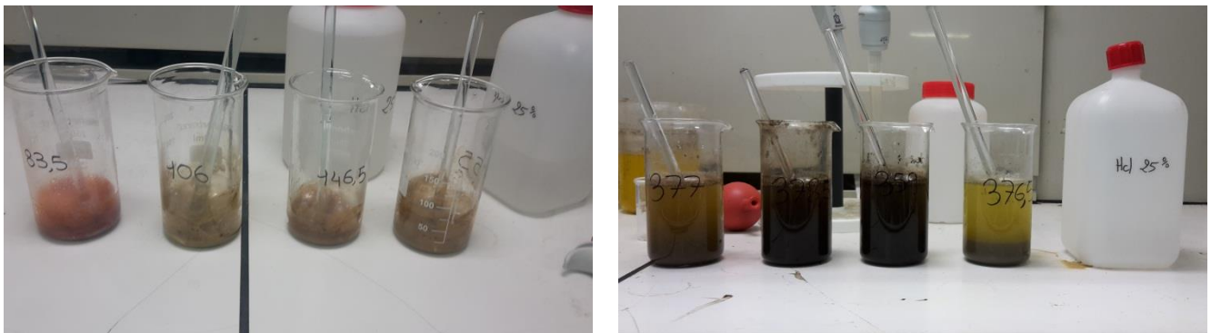
Fig5.3: Etape de décarbonatation des échantillons à l'HCl 25%
