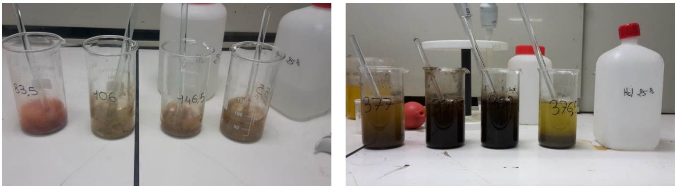
Fig5.3: Etape de décarbonatation des échantillons à l'HCL 25%
