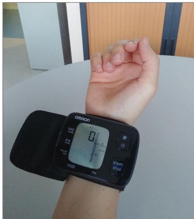
Figure 4.2. Le tensiomètre de poignet Omron RS6. Deux flèches sur l'écran indiquent que l'utilisateur doit baisser son bras. Le zéro indique que le tensiomètre est en train de mesurer la tension artérielle.
