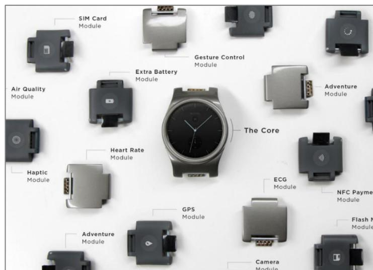
Figure 5.11. Illustration de la montre Blocks ainsi que plusieurs de ses modules.
