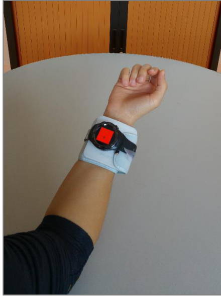
Figure 4.4. Le système développé pour guider l'utilisateur à positionner correctement un tensiomètre de poignet à l'aide d'une montre connectée.
