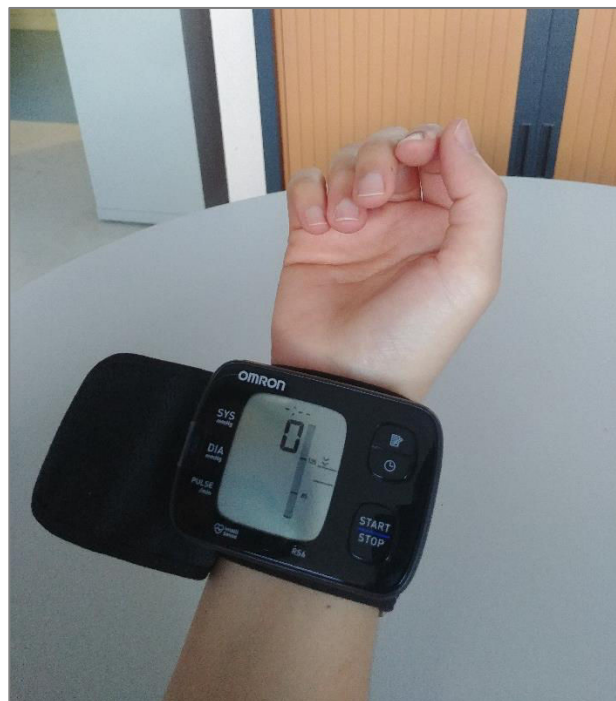
Figure 4.2. Le tensiomètre de poignet Omron RS6. Deux flèches sur l'écran indiquent que l'utilisateur doit baisser son bras. Le zéro indique que le tensiomètre est en train de mesurer la tension artérielle.
