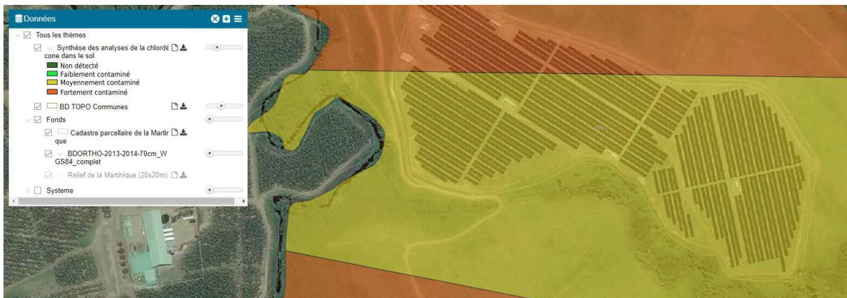
Figure 88 : Contamination à la chlordécone au niveau de la centrale Lasalle, sur la commune de Sainte-Marie. En orange, les zones de forte concentration, en jaune celles de moyenne concentration et sans couleur les zones non analysées.
