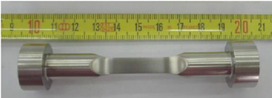
Figure 103: Eprouvette CC (« Corner Crack ») utilisée pour les essais de propagation de fissure dans le cadre du programme RAMGT.
