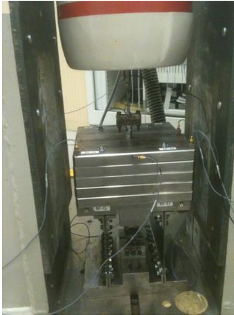
Figure 165 : Photo prise sur le montage comportant cinq masses supplémentaires et les accéléromètres pour l'analyse modale.
