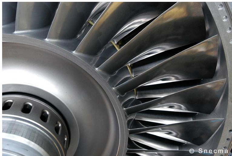
Figure 2 : Disque monobloc aubagé (DAM) du moteur GE90-115B.
