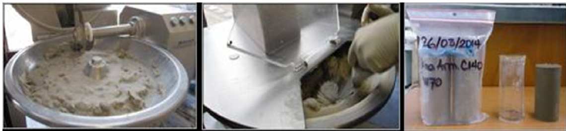
Figure 121. Réalisation des mélanges sol-ciment dans un malaxeur de type Hobart (Duc et al, 2019)
