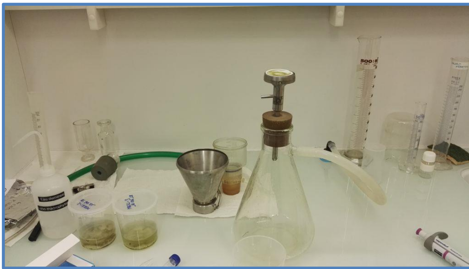
Figure 12: Photographie du système de filtration Buchner utilisé pour la détermination du poids sec et de la chlorophylle a .
