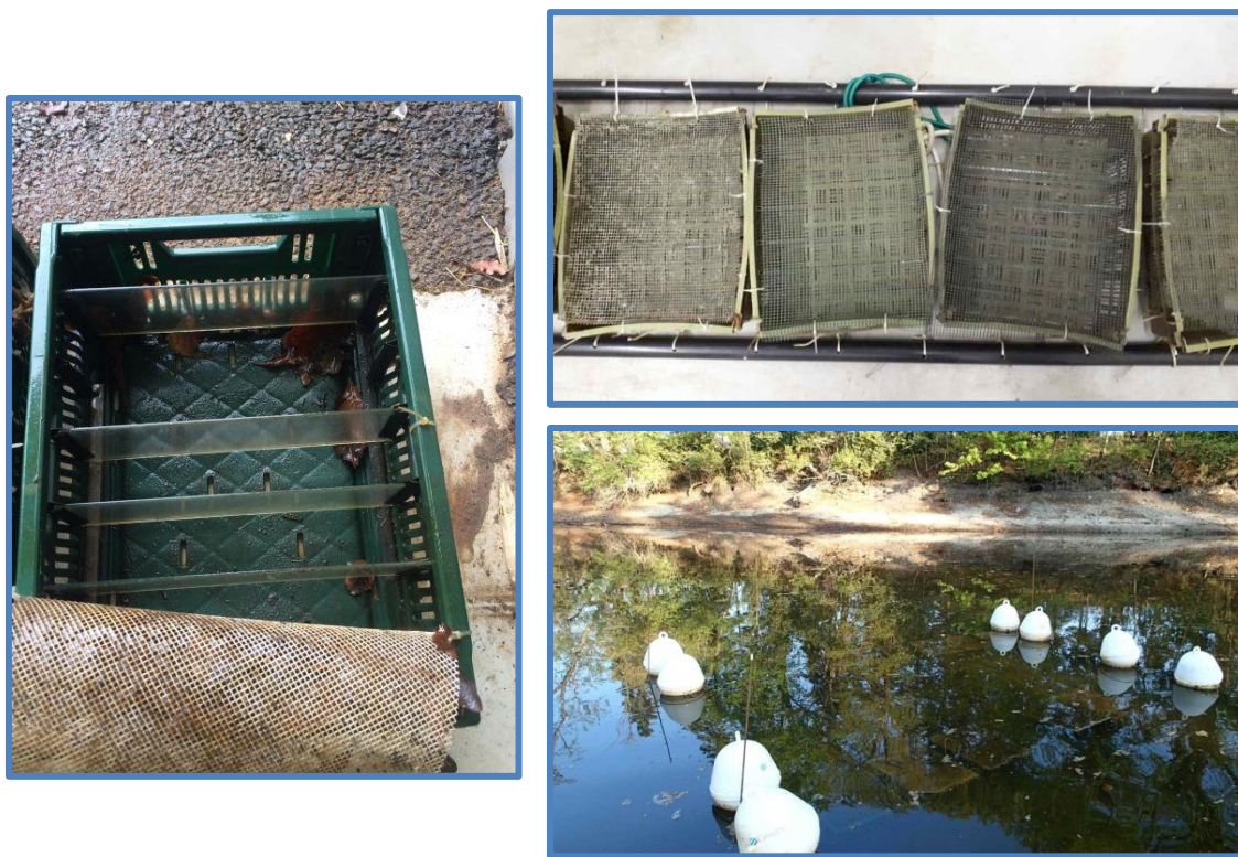
Figure 7: Photographie du matériel de colonisation. Une série de cagettes disposée sur un dispositif flottant en PVC en haut à droite, contenant des lames de verres à gauche, immergée à une vingtaine de centimètres en dessous de la surface, en bas à droite.
