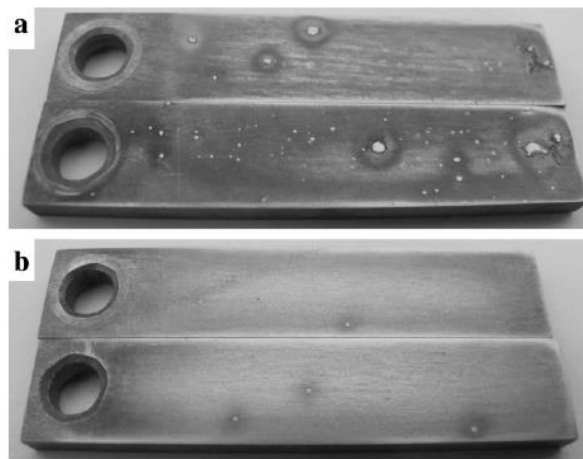
Figure I.17 Analyse des cloques sur des éprouvettes immergées dans une solution 5% NaCl à différentes pressions partielles de \text{H}_2\text{S} (a) 1.MPa (b) 0.1MPa [Zhou2013].
