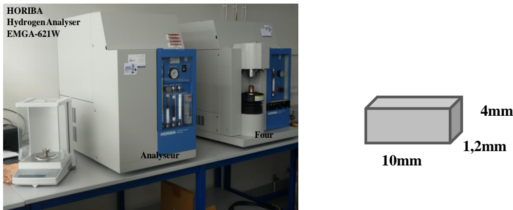
Figure II.32. Illustration des dimensions d'un échantillon destiné à la TDS et photographie de la TDS utilisée lors de cette étude.
