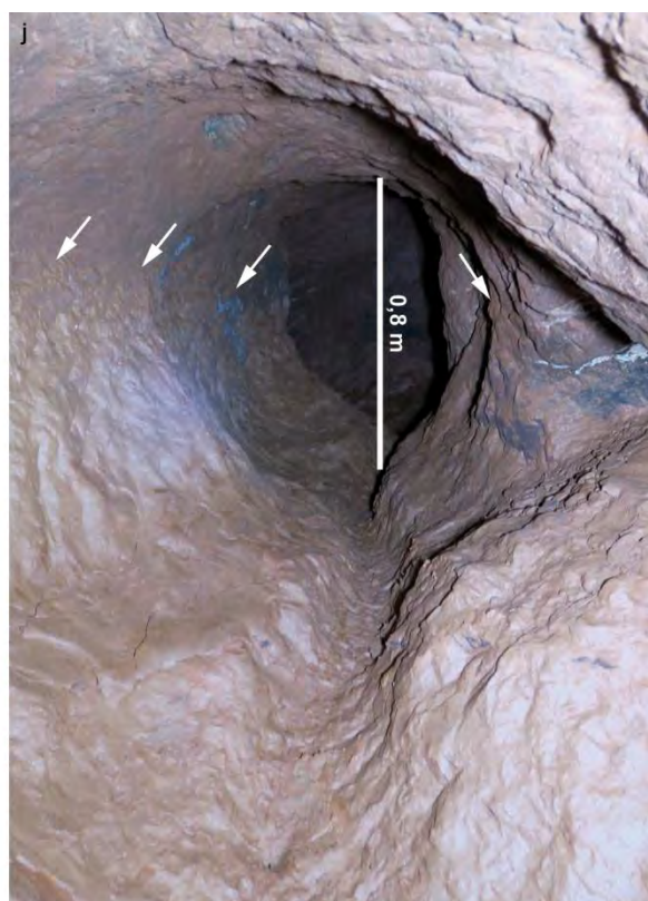
Fig. 121 : Le Goutil Ouest : encoches de boisage et canal d'exhaure.
