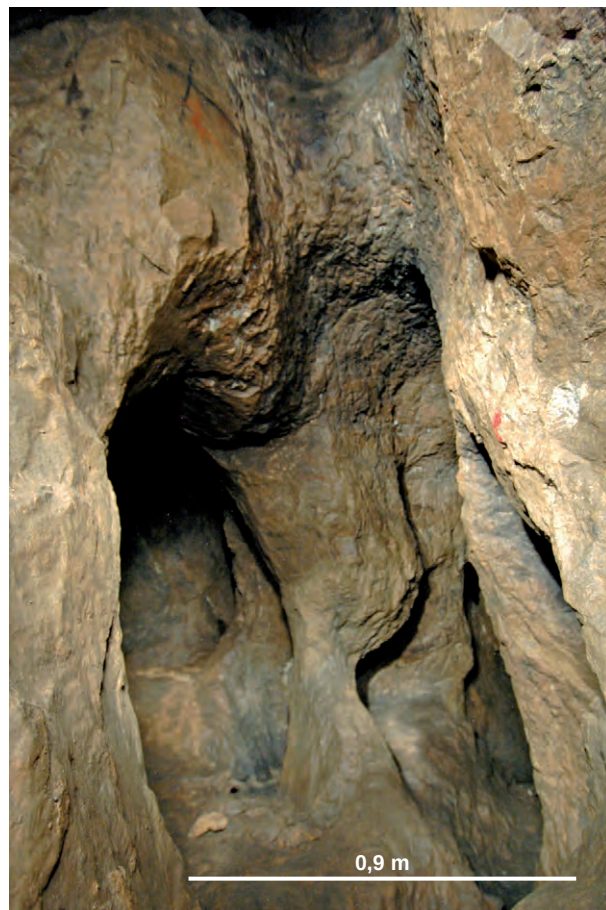
b. Aspect labyrinthique des travaux au centre du réseau, angulaires ou ovoïdes, au feu et à l'outil, dans toutes les directions et sur plusieurs niveaux (cliché J.-M. Fabre).
