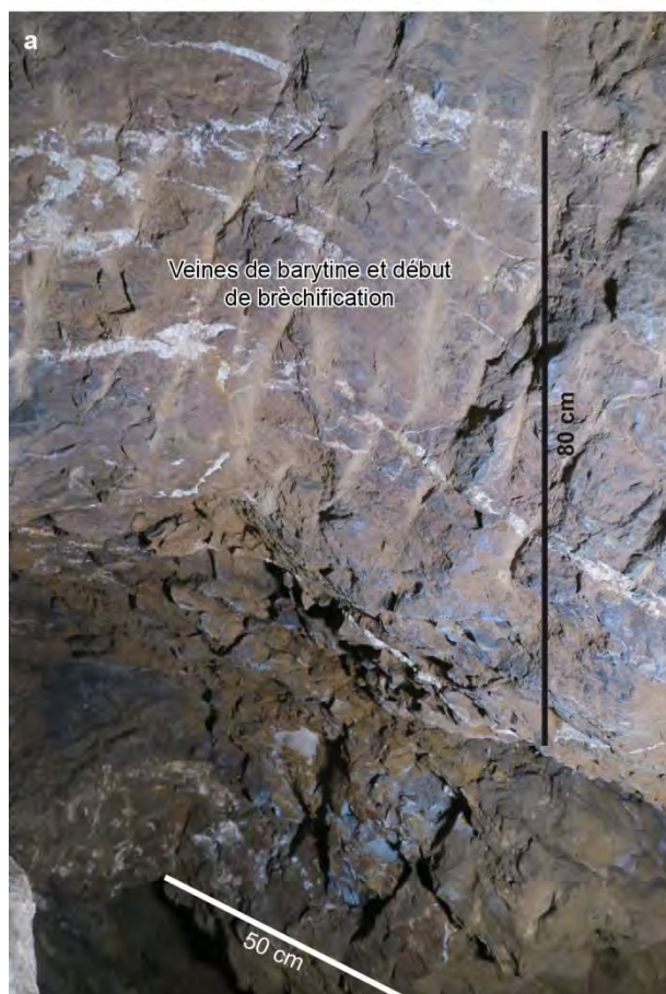
Fig. 107 : Brèche hydraulique et minéralisation dans le réseau Est du Goutil.
