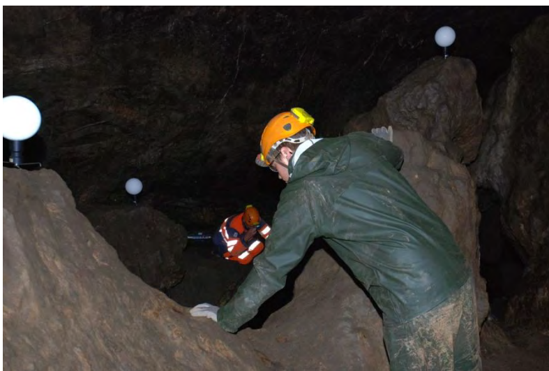
Fig. 17 : Mise en place des cibles et vérification du contact visuel (cliché B. Cauuet).
