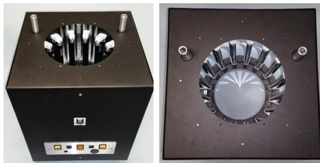
Figure 78 : Système Rayonet RPR-200
