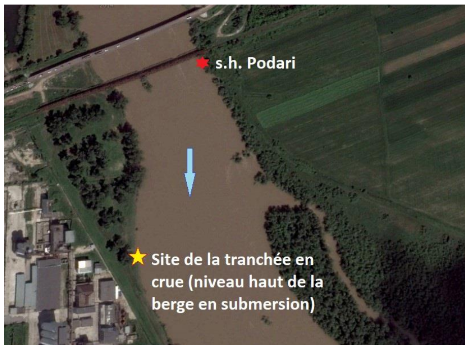
Figure VII.14. Mise en submersion de la berge lors de la crue de mai 2014 ( Q = 859 \text{ m}^3 \cdot \text{s}^{-1} ; H = 857 \text{ cm} ). Le volume total de la crue (1-11 mai 2014) a été de 4561 \cdot 10^3 \text{ m}^3
