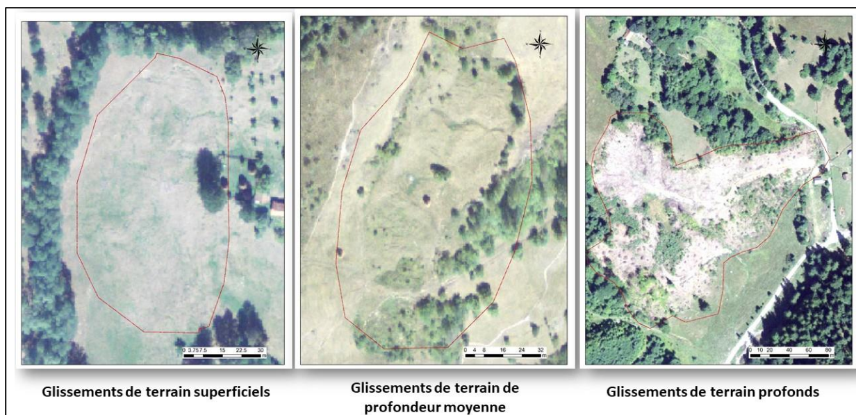
Figure IV.13. Trois exemples de glissements de terrain différenciés par leur profondeur (Source des images : ANCP)
