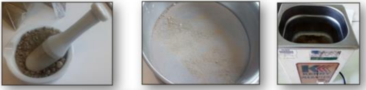
Figure VIII.22. Etapes de préparation des échantillons pour l'analyse en carbone totale
