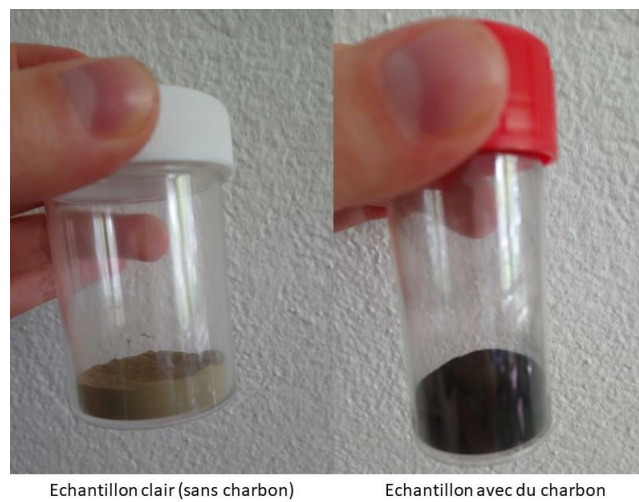
Figure VIII.16. Différences entre la couleur d'un échantillon propre (sans charbon) et un autre avec des particules de charbon
