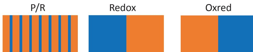
**Figure 0-3 : Schéma des différentes activations : P/R, REDOX et OXRED. En orange, séquence P ou 20%O<sub>2</sub>/He et en bleu, séquence R ou 10%H<sub>2</sub>/He.**
