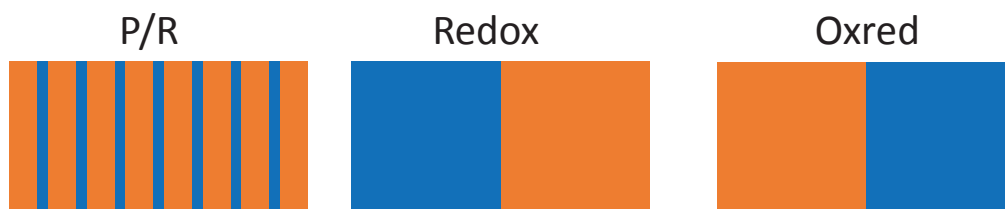
Figure 0-3 : Schéma des différentes activations : P/R, REDOX et OXRED. En orange, séquence P ou 20%O 2 /He et en bleu, séquence R ou 10%H 2 /He.
