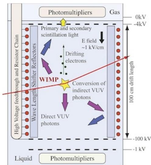
Figure 16 – Principe de fonctionnement d’une TPC double phase.
