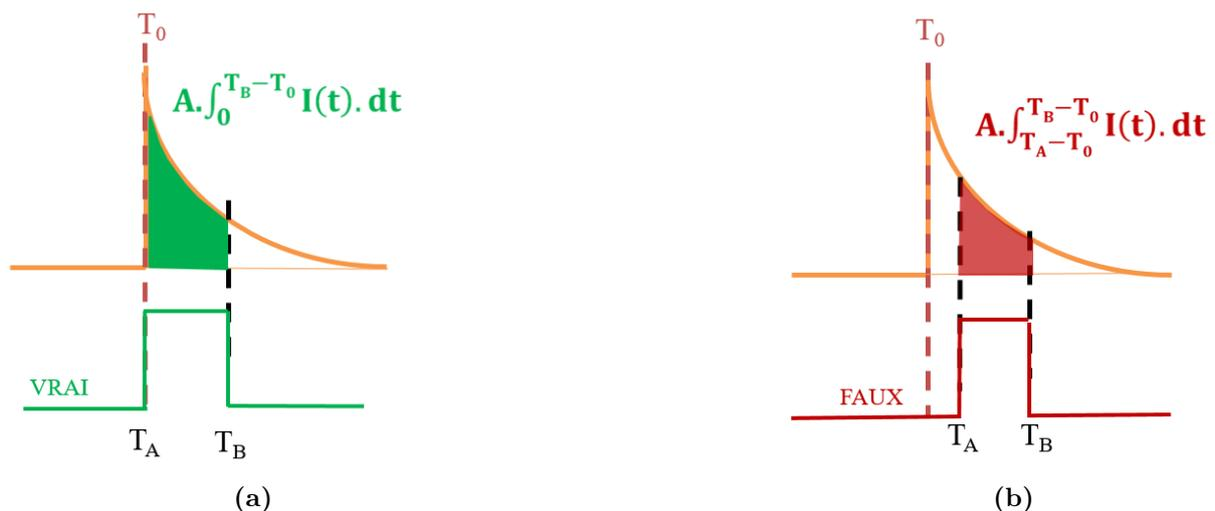
**Figure 3.55** – Représentation de la valeur de l'intensité lumineuse calculée par les simulations des évènements apparaissant dans la fenêtre d'exposition de la caméra lorsqu'une partie ou toute l'intensité lumineuse est enregistrée (figure 3.55a) ou lorsque des évènements apparaissant en dehors de la fenêtre d'exposition de la caméra (figure 3.55b)
