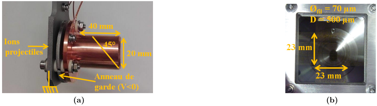
Figure 2.4 – Figure 2.4a : Photographie de la cage de Faraday permettant la mesure de l’intensité du faisceau d’ions projectiles. Figure 2.4b : Photographie du profileur XY permettant de mesurer la position du faisceau d’ions dans le plan vertical et horizontal.
