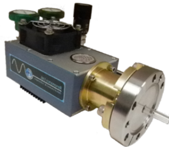
Figure 2.11 – Photographie de la lampe UV utilisée afin de créer un faisceau de photons d’énergie 21,22 eV.
