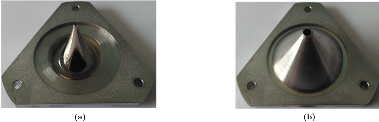
Figure 2.19 – Figure 2.19a : Photographie de l'écorceur hyperbolique de diamètre 1 mm. Figure 2.19b : Photographie de l'écorceur de forme conique et de diamètre 2 mm.
