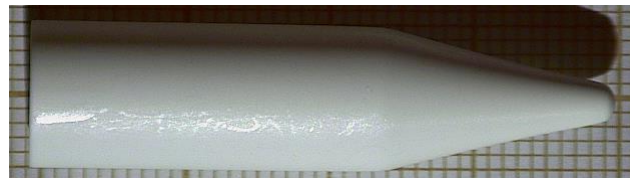
Figure 48 : Creuset de pBN à fond conique ( 30^\circ )
