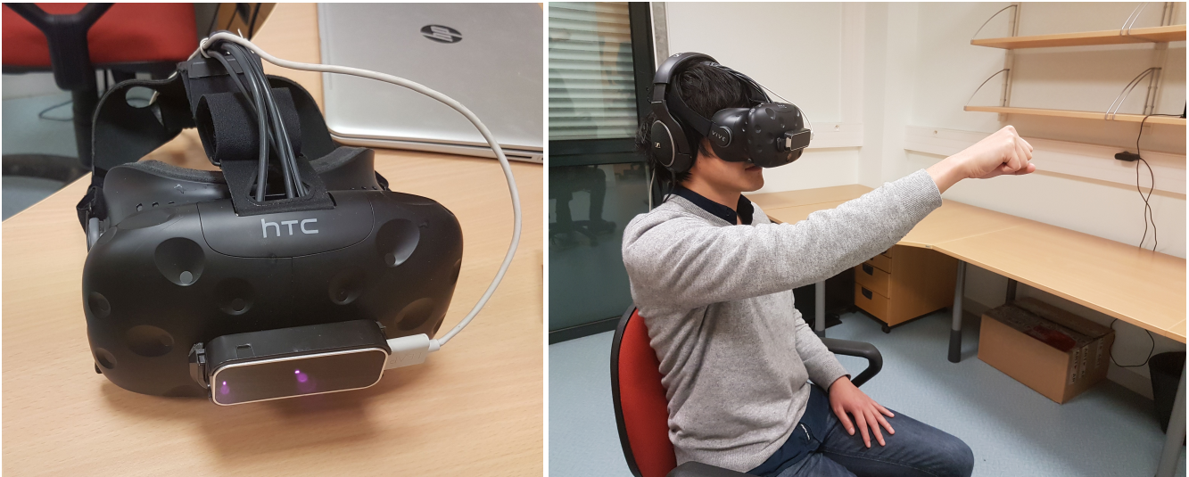
FIGURE 3.7 – Image de gauche : le Leap Motion fixé sur le casque HTC. Image de droite, un participant dans la salle de téléopération portant la combinaison HTC+Leap et le casque audio.
