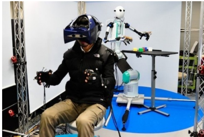
FIGURE 1.2 – TELESAR V - la cinquième génération de robots anthropomorphes de substitution de télé-existence.
