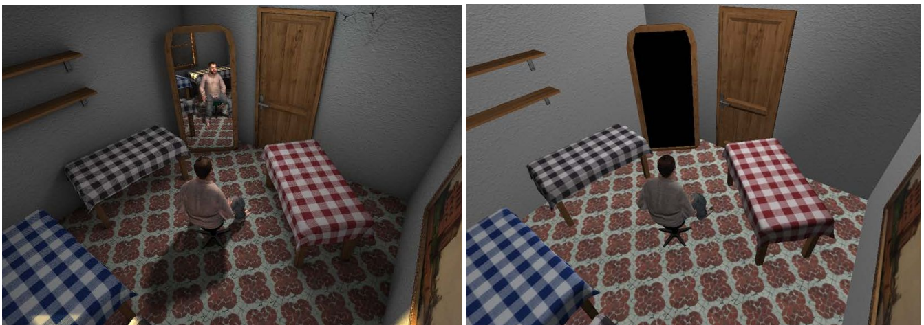
FIGURE 1.11 – Vue d'ensemble de l'environnement virtuel. Image de gauche : configuration avec un degré d'immersion et de cohérence maximal : rendu avec illumination, ombres dynamiques et réflexion en temps réel. Image de droite : configuration de « mauvaise qualité » : ombrages simplifiés (Gouraud) et absence d'illumination et de réflexion [7].
