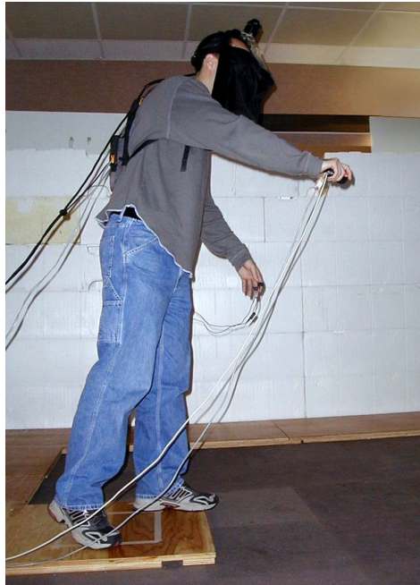
FIGURE 1.10 – Un participant portant un visiocasque et un équipement mesurant la fréquence cardiaque [6].
