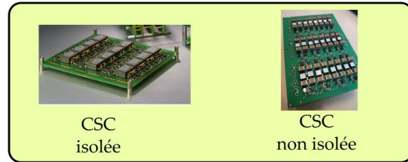
Figure I-13 Présentation des deux familles de CSCs et leur déclinaison en version intégrée sur PCB ou mezzanine
