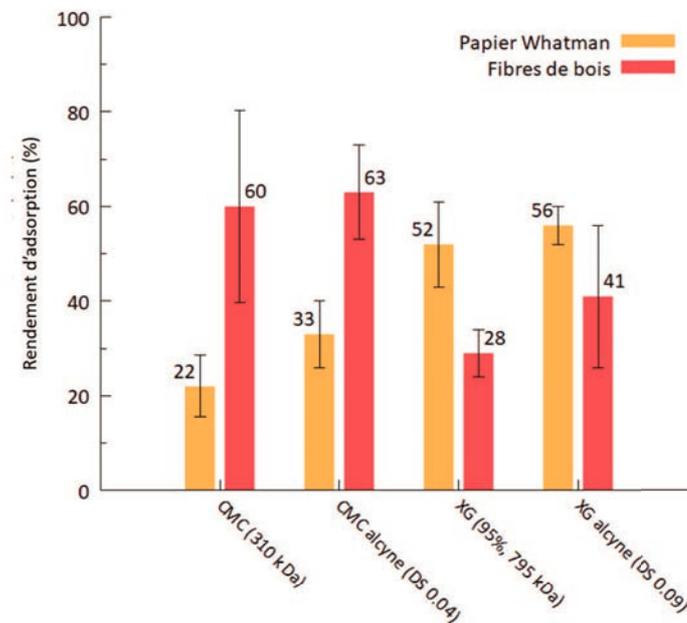
**Figure IV.6** – Quantité de CMC et de XG alcyne (5 g/L) adsorbée sur différents substrats ( $m = 0,5$  g)
