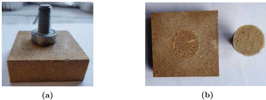
Figure IV.24 – Test pull off a) avant et b) après décollement sur un panneau de bois revêtu de XG allyle avec la finition U500
