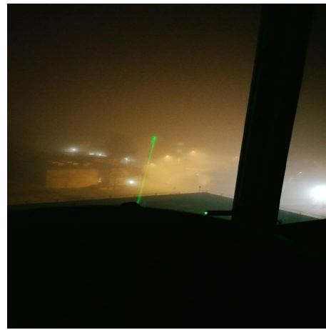
FIGURE 3.15 – Alignement du télescope et du rétro-réflecteur à l'aide d'un laser visible.
