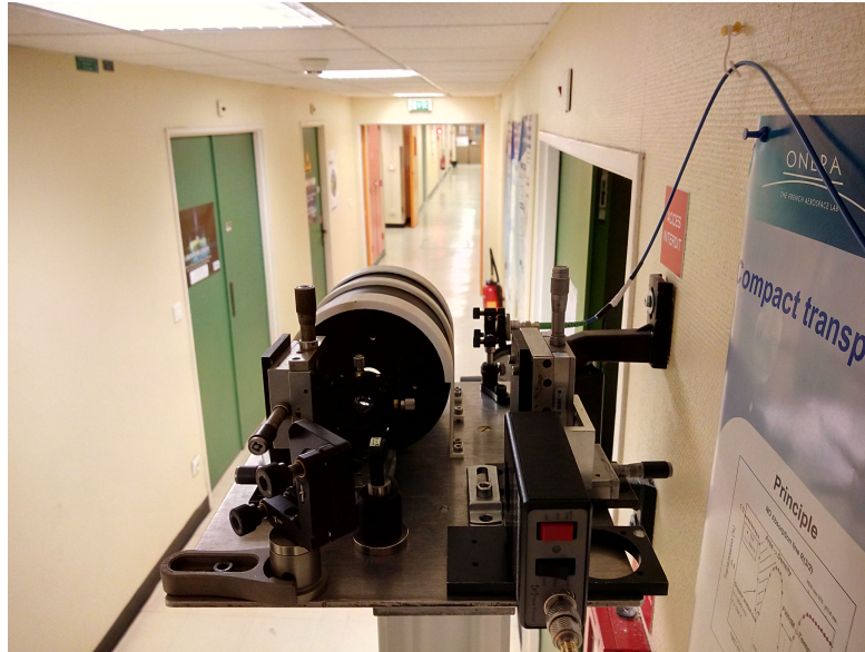
FIGURE 3.6 – Image du télescope utilisé pour récolter la lumière portant l'information sur les 55 m d'atmosphère sondés.
