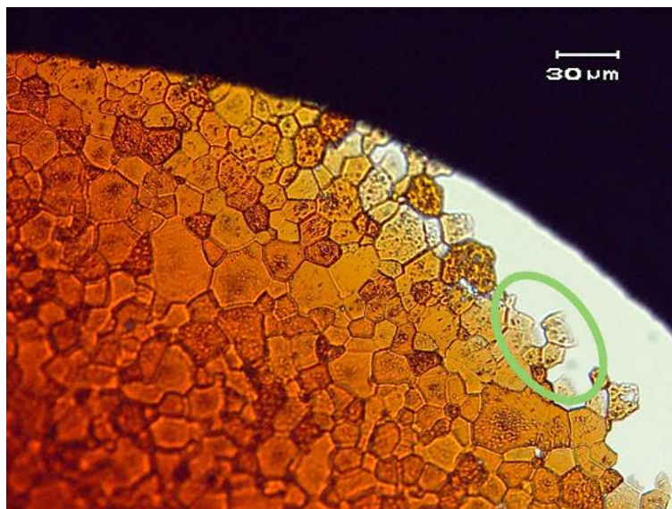
Figure 2-6 : Image en microscopie optique en lumière transmise d'un échantillon d' \text{UO}_2 présentant des zones transparentes aux électrons. La zone entourée en vert contient quelques grains assez minces pour être observés en MET.
