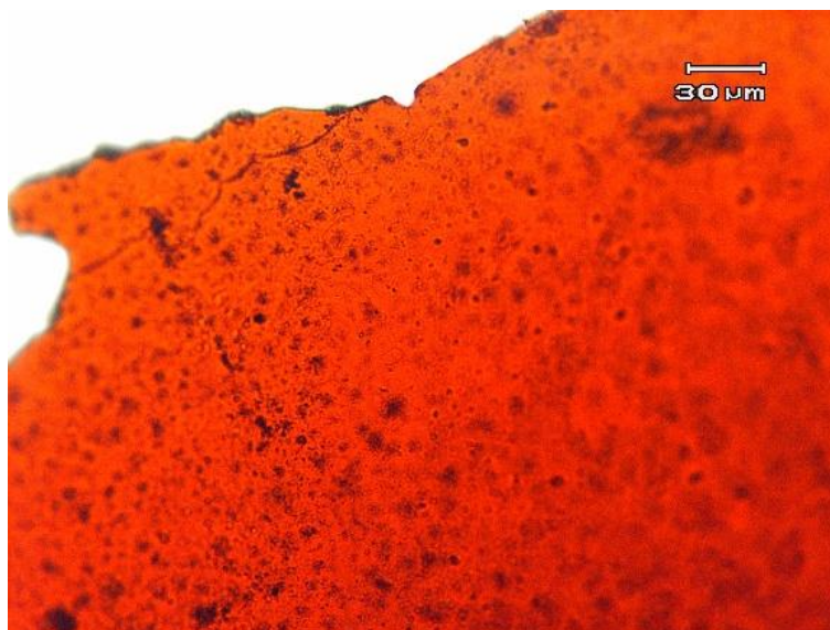
Figure 2-5 : Image en microscopie optique en lumière transmise d'un échantillon d' \text{UO}_2 aminci par frottement abrasif doux.
