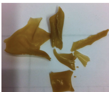
Figure V. 3 : Thermodurcissable obtenu par trimérisation du NC-EKKE-CN para substitué
