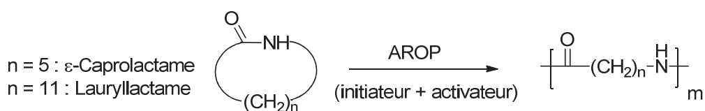
Figure I. 19 : AROP de PA-6 et PA-12
