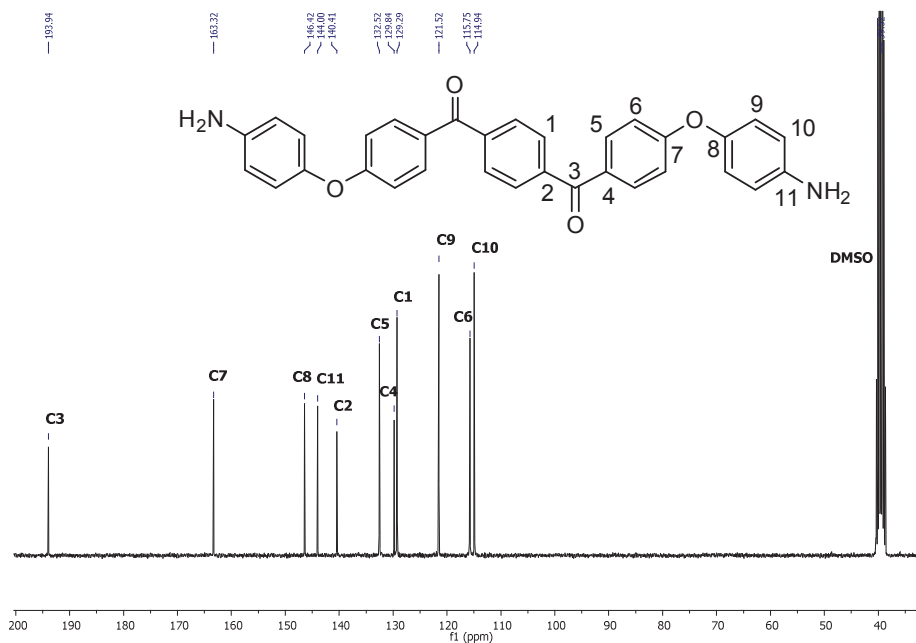
Figure 9 : Spectre RMN ^{13}C (75Mhz) du H_2N-EKKE-NH_2 commercial brut dans le DMSO-d_6
