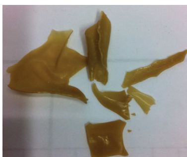
Figure V. 3 : Thermodurcissable obtenu par trimérisation du NC-EKKE-CN para substitué
