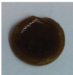
Figure V. 17 : Matériaux obtenu par le couplage H 2 N-EKKE-NH 2 / DGEBA (essai P25)
