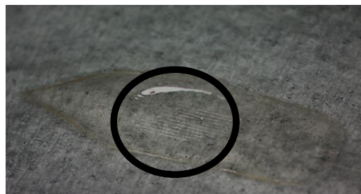
Figure 86 : Pointe en PLGA avec fils de SU-8, découpée par découpe laser. Des fils de SU-8 sont englobés dans le PLGA (cercle noir)
