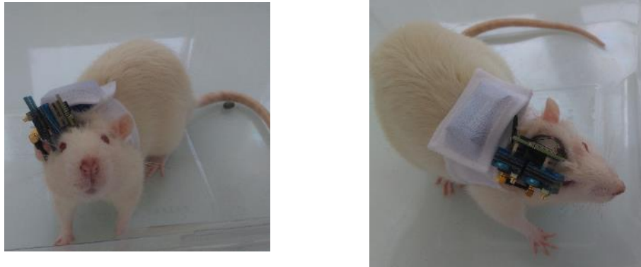
Figure 93 : Rat implanté avec l'ensemble carte PCB, headstages et batteries connecté au cicor.
