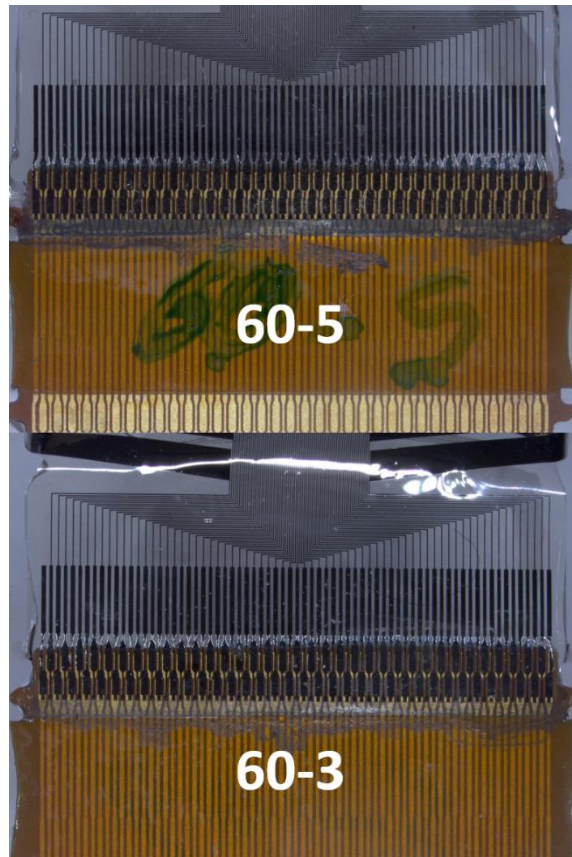
Figure 78 : Photos de la connexion implant/cicor. En haut : Mauvaise connexion (impédance élevée) En bas : Bonne connexion (impédance faible)
