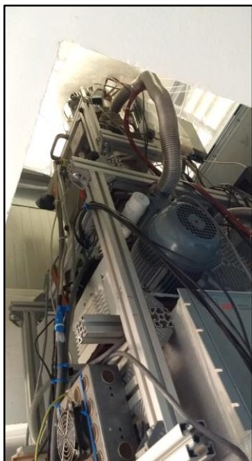
Figure 21 : CIMS utilisé pour la détection de l'acide sulfurique H_2SO_4 .
