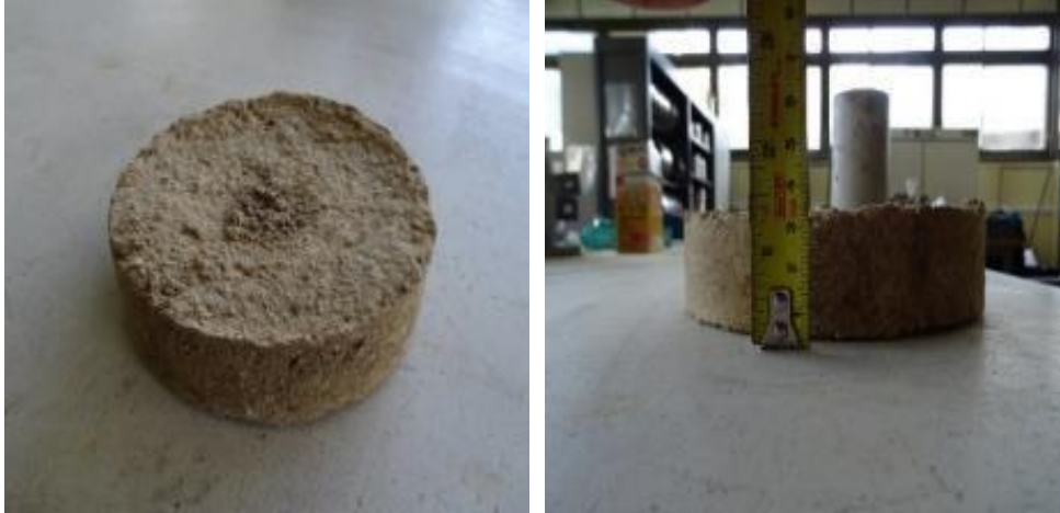
Figure 100. Exemple d'éprouvette d'arène granitique humidifié à 7,5% et compactée dans le moule Proctor
