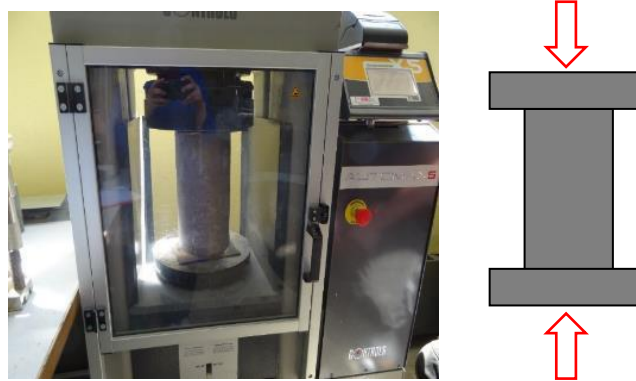
Figure 89. Essai de compression sur les échantillons d'éprouvettes prélevées lors du coulage de la structure
