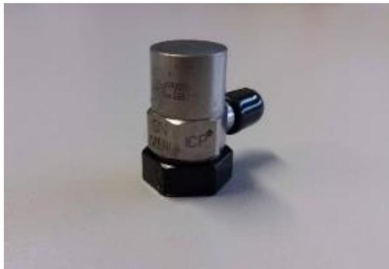
Figure 91. Capteur d'accélération ICP®
