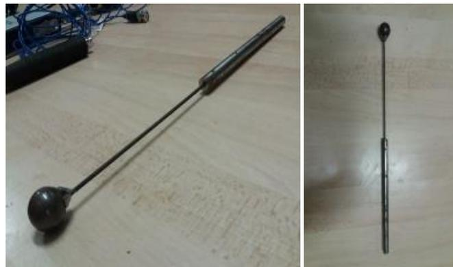
Figure 86. Système d'Impact avec une bille de 2 cm de diamètre élaboré au laboratoire GC2D
