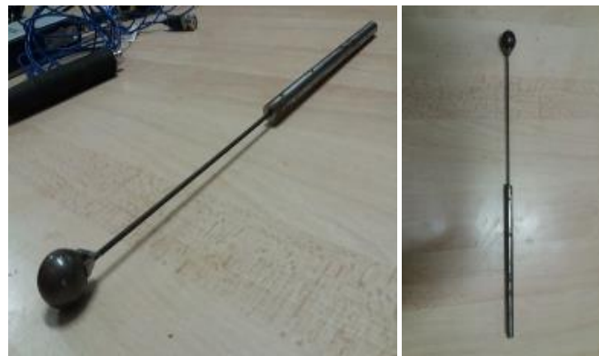
Figure 86. Système d'Impact avec une bille de 2 cm de diamètre élaboré au laboratoire GC2D
