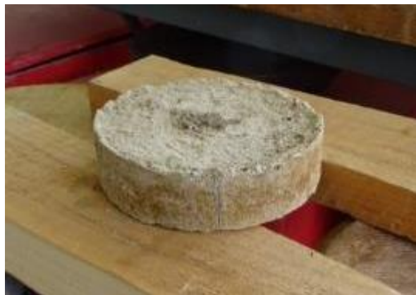
Figure 103. Éprouvette d'épaisseur 4,5 cm constituant la deuxième couche
