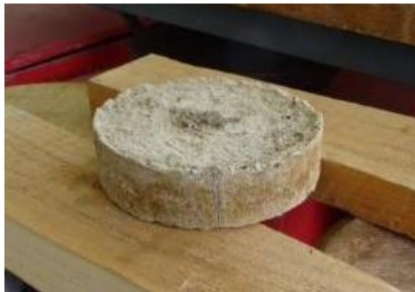
Figure 103. Éprouvette d'épaisseur 4,5 cm constituant la deuxième couche
