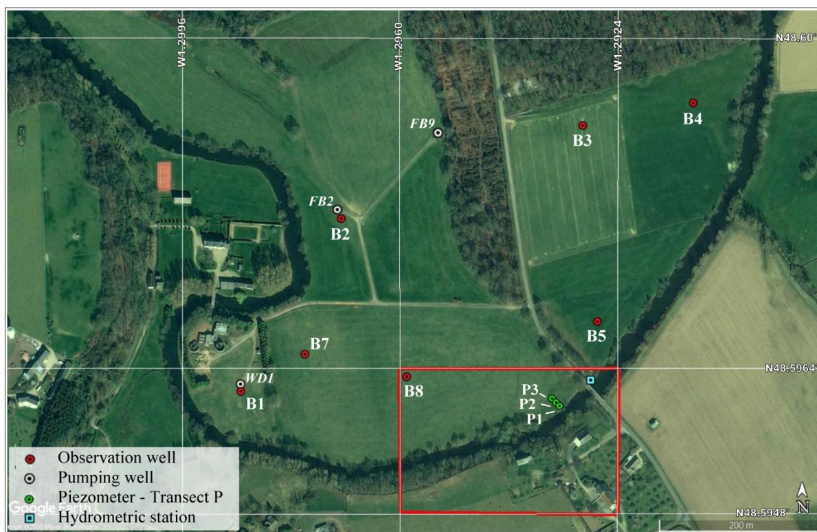
Figure 3-6. Ensemble des forages et piézomètres présents sur le champ captant. Le rectangle rouge indique la partie du tronçon où les échanges nappe/rivières ont été étudiés à l'échelle locale.
