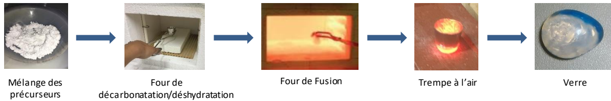
Figure 1: Les différentes étapes de la synthèse des verres par fusion trempe
