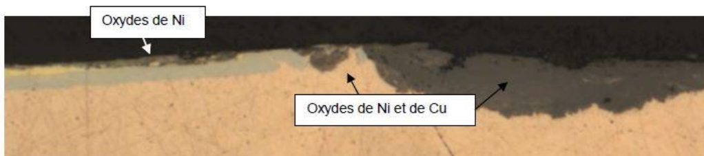
Figure 1.7 : Observation en coupe de la trace d'usure par fretting sur contact laiton/Ni/Ag (rapport d'expertise PSA).
