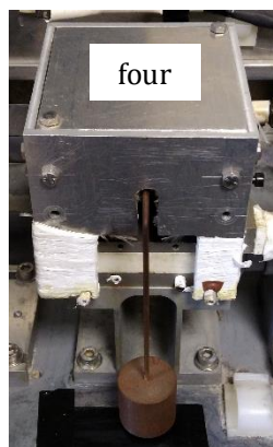
Figure 2. 3: Système de chauffage utilisé sur FC I.
