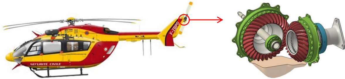
Figure 71 : Emplacement de la BTA sur appareil et vue isométrique de la boîte sans carter.
