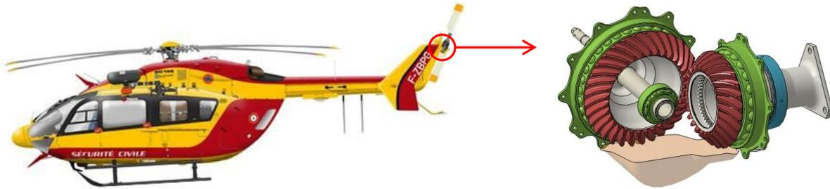
Figure 71 : Emplacement de la BTA sur appareil et vue isométrique de la boîte sans carter.
