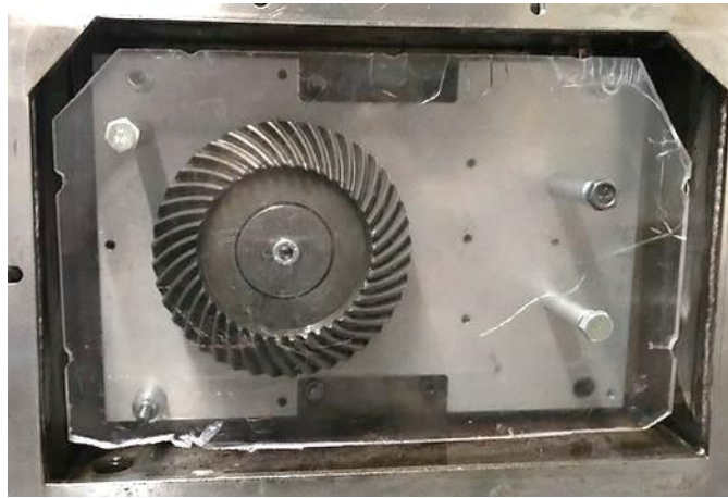
Figure 61 : Photo du montage d'une roue avec flasques, configuration 3.
