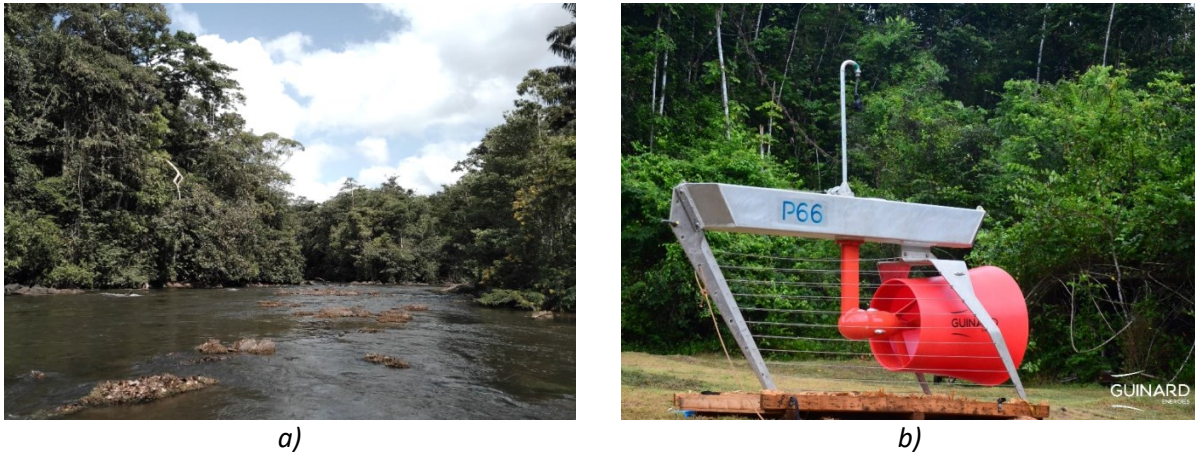
Fig VI.5 : a) Emplacement pour l'hydrolienne sur l'Arataye, b) Hydrolienne P66 de Guinard Energies en attente de mise à l'eau au camp Pararé [8].
