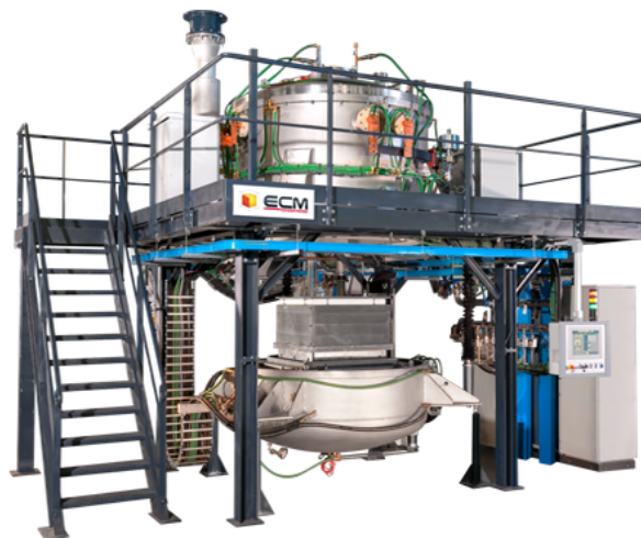
FIGURE 1.9 – Four industriel ECM produisant des lingots de section carré (90x90cm) type G6 d'un poids de 450 à 600 Kg (CEATech)
