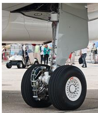
Figure 1.4 Green Taxiing : moteur électrique pour entraîner l'avion au sol
