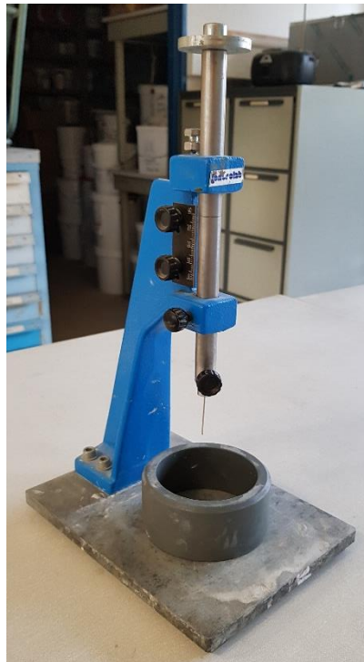
Figure 33 – Appareil de Vicat équipé d'une aiguille pour le suivi du temps de prise
