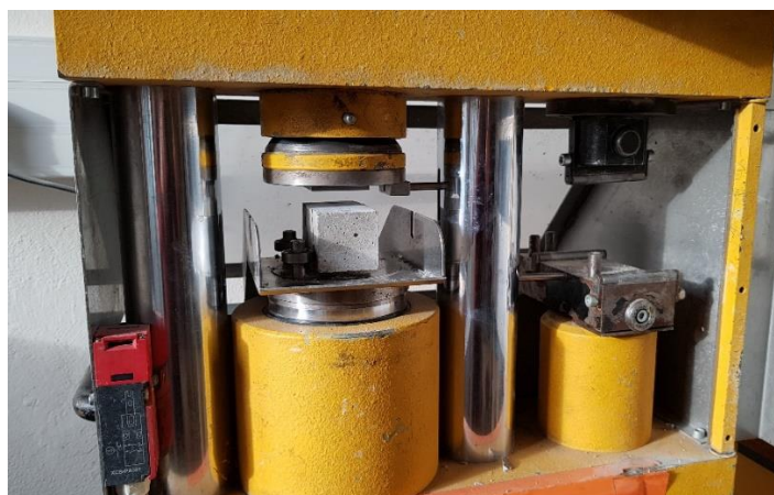
Figure 34 – Presse pour essais mécaniques de résistance en compression
