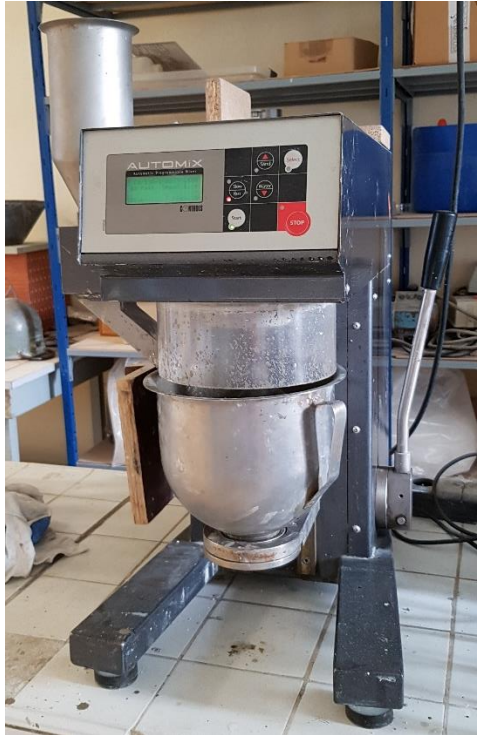
Figure 32 - Malaxeur à mortier normalisé
