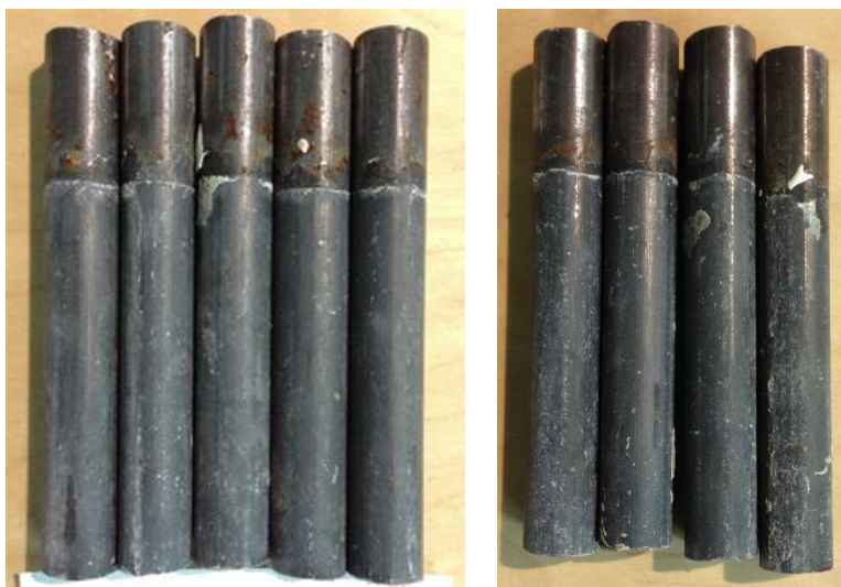
Figure 115 - Autopsies des armatures des formules 50% laitier activé avec CaCl 2 (à gauche) et R+ (à droite)
