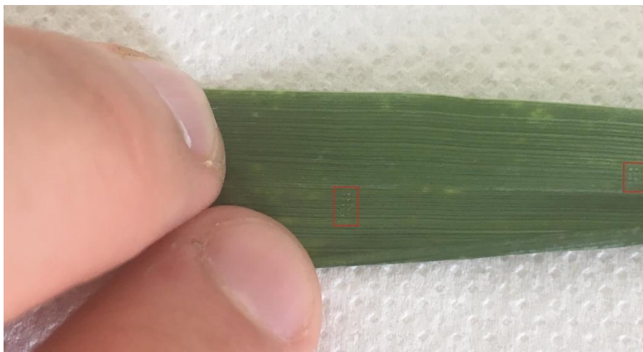
Figure 4-2 : Photo d'une feuille de blé réalisée après analyse LIBS. Les rectangles rouges indiquent les 2 zones d'analyse LIBS effectuées.
