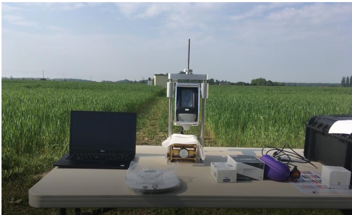
Figure 4-2 : photo de l'instrument LIBS Z-300 monté sur un support lors de la campagne de mesures réalisée sur des parcelles de blé Qualiagro.
