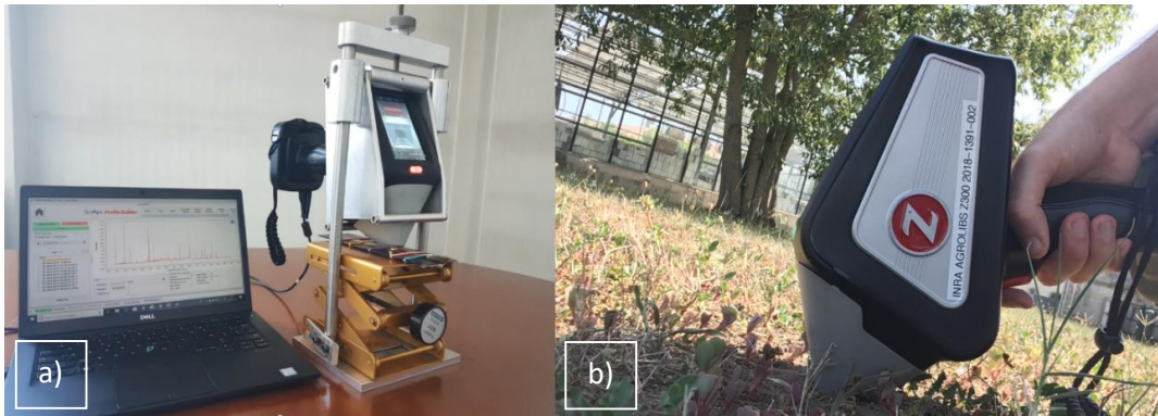
Figure 1-6 : Photo montrant l'instrument Z300 a) sur un châssis pour un usage en conditions de laboratoire, et b) en main pour un usage en dehors du laboratoire (notons que cette photo sert uniquement d'illustration et ne correspond pas à une mise en œuvre réaliste pour l'analyse in-situ d'un sol).
