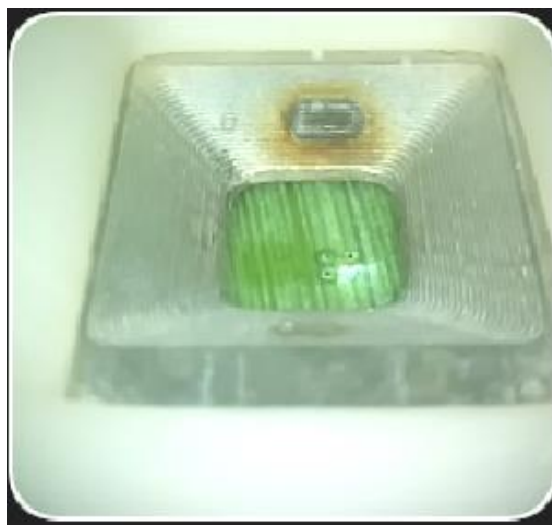
Figure 4-3 : Photo de la fenêtre de tir lors de l'analyse LIBS des feuilles de blé avec le Z-300.
