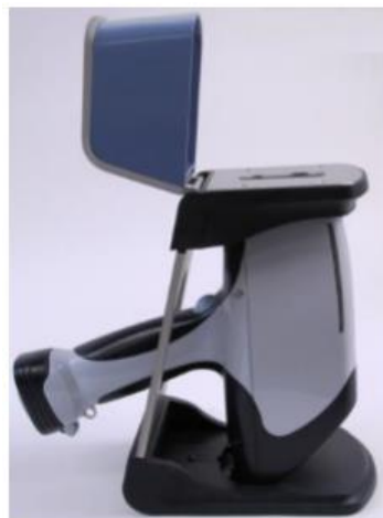
Figure 1-4 : Photo de l'instrument de XRF portable, SI 800 Titan, développé par Bruker [46] et utilisé dans le cadre de cette étude.
