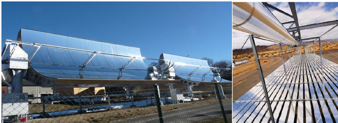
Figure I-10 : Centrales solaires à concentration linéaire. A gauche : modules cylindro-paraboliques au laboratoire Promes (Odeillo- France). A droite : miroirs linéaires de Fresnel et tube absorbteur
