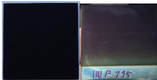
Figure IV-25 : Echantillons avant vieillissement - à gauche : revêtement de type B, à droite : revêtement sélectif de type F
