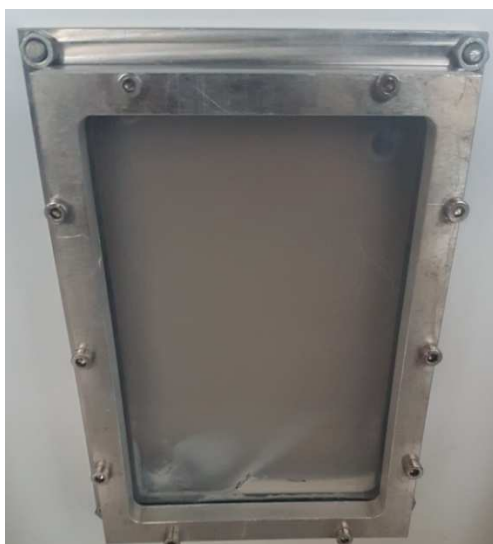
Figure A-96 Photographie du photo-réacteur vue de face et du TiO_2 qui décante.
