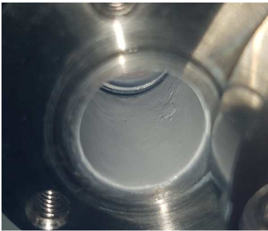
Figure A-95 Photographies de la chambre contenant le fritté en inox.
