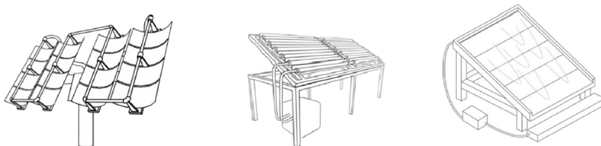
Figure 1-1 Dessins des réacteurs solaires PTC, CPC et IPC (Zhang et al., 2018).
