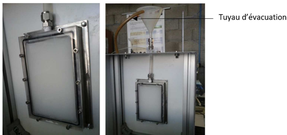
Figure 3-43 Photographies du photo-réacteur en vue de face rempli de dioxyde de titane à 3 \text{ kg.m}^{-3} et du décanteur avec le tuyau d'évacuation.
