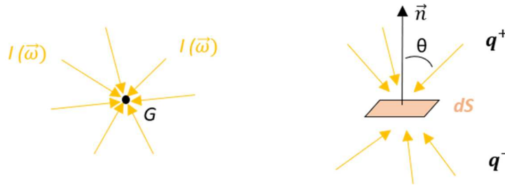
Figure 2-13 Schémas de l'irradiance (à gauche) et des densités de flux hémisphériques positives et négatives (à droite).
