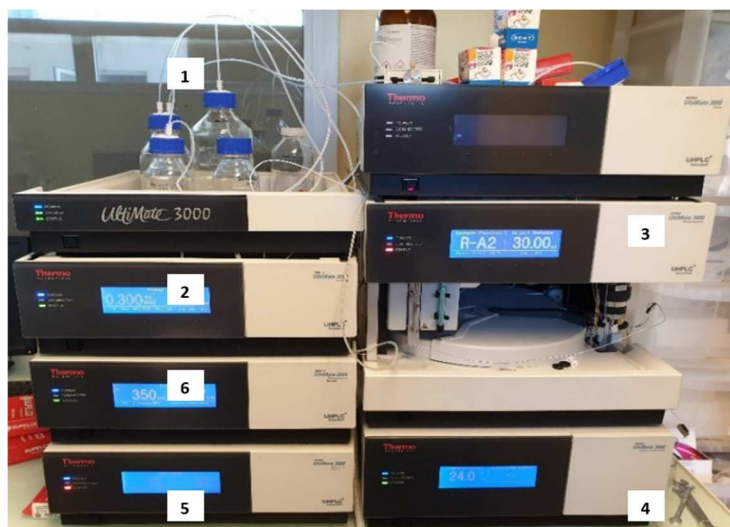
Figure 3-34 Photographie de la HPLC-UV UltiMate3000. 1 : Éluents ; 2 : Pompes ; 3 : Échantillonneur ; 4 : Colonne ; 5 : spectrophotomètre UV-visible ; 6 : Fluoromètre.
